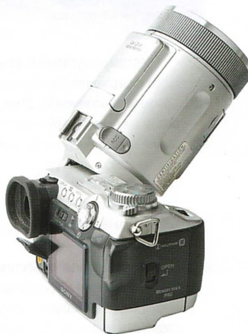
В этой модели поворачивается не экран, а объектив
