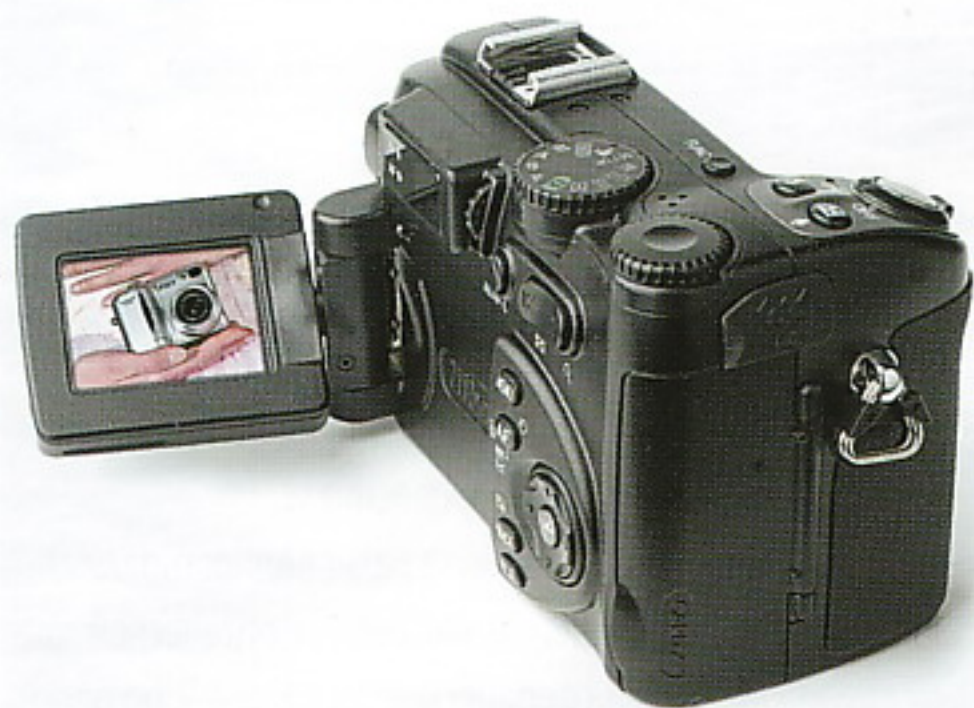
Камера с поворотным контрольным экраном
